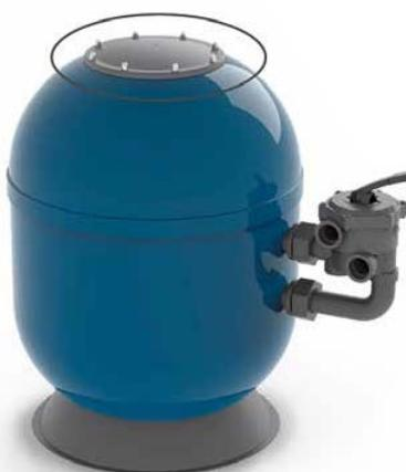
Filtri laminati in poliestere con valvola laterale, particolarmente adatti per piscine private e commerciali, composti da valvola selettrice a 6 posizioni (filtrazione, lavaggio, risciacquo, ricircolo, svuotamento e chiusura), manometro e spurghi aria.
